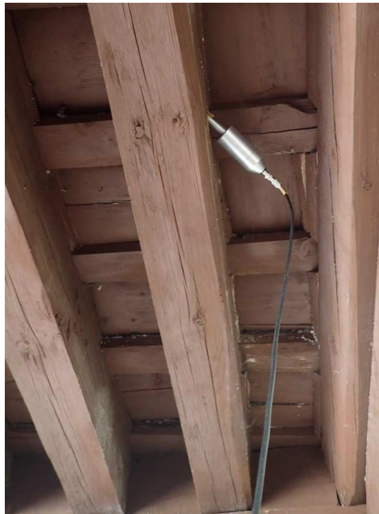
Imagen 4. Ejemplo de aplicación de la técnica de emisión y recepción de ultrasonidos a una vigueta de madera de un edificio histórico.
